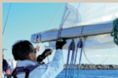
4 リーチのリーフクリングルには、リーフロープとは別のロープを使って補強。セールタイなどは使わずロープできつく結ぶ
