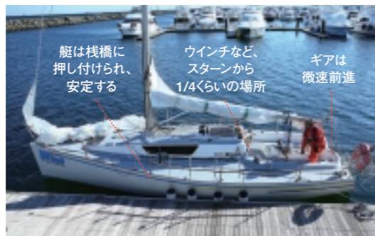
これがワンラインドッキングの状態。微速前進することで艇が桟橋に押し付けられる力が働き、たった1本のロープによって、安定して着岸されている
