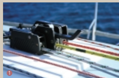
1 まずメインシートをリリースし、メインハリヤードをゆるめる。あらかじめマーキングしておくこと(写真黄色のロープ)
