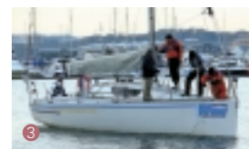
3 船尾側のアンカーを投入し、水深の3倍分前進し(二つのアンカーの中心)、2本のアンカーラインを結束
