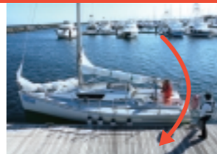
舵を桟橋側に押すことで、船尾が桟橋に近づく。スターンを舫う場合はこのように舵でアシスト
