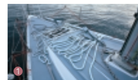
1 アンカーロード(チェーンとロープ)は絡まぬようフレグコイルにせず、互い違いにしておく
