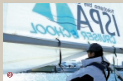
3 リーフロープを引き、垂れ下がったセールを、ブームに固定。リーフロープが外れた際にセールを破かぬよう、ゆるめに巻くこと
