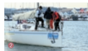
2 船首からアンカーを投入し、利いたことを確認したらそのまま風下方向に、水深の6倍分後進する
