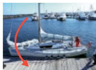
舵を沖側に押すことで、船首が桟橋に近づく。クルーの作業に合わせて艇の角度を変えよう
