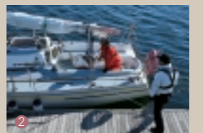
2 桟橋に降りたクルーは、係留ロープをクリートに1周させ、迅速にワンラインドッキング状態を作る。ヘルムスマンは微速前進のままギアをキープする。クルーは、艇が桟橋と平行になるようロープの長さを調整する
