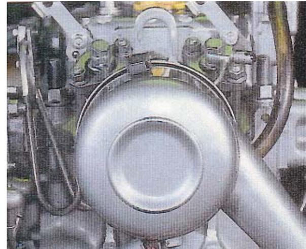
デコンプレバーは吸気サイレンサーの上、燃料噴射弁と並ぶようについている(2GMの場合は2つ並んでいる)。持ち上げると開放になり、さげると圧縮状態となる(写真状態)
