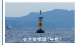
アシカ島の東南東にある「笠島」は、干潮時で約0.9m干出します。他にも危険な暗礁があるため、東方標識として「笠島灯浮標」が設置されており、アシカ島と笠島灯浮標の間は、危険水域であると標識で示されています。
